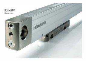
X、Y轴直线电机,具有超高推力密度,低顿力,配有海德汉全闭环高精度直线光栅尺,直线光栅尺具有测量方向上的高刚性,热特性好等 特点,全闭环控制模式能消除潜在的多个误差源,从而保证了机床高精度定位和高速加工时的稳定性,且长期持久。Z轴采用高扭矩输出 NUM伺服电机,可配直线轴光栅尺。
